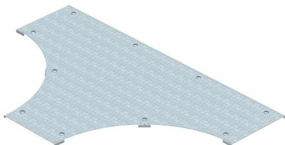
Coperchio per derivazione a T, pesante, con bussole girevoli premontate. Poiché il connettore è montato dall'esterno, il coperchio del raccordo è più corto di 300 mm rispetto al raccordo corrispondente. Questo deve essere considerato quando si installano gli elementi della linea.
