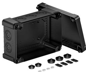
Scatola di derivazione per il collegamento di cavi e linee in ambienti interni e ambienti esterni. Forma quadrata, con passacavi. Adatta per il montaggio su pareti e soffitti con la possibilità di fissaggio esterno e interno e su sezioni angolari. Resistente agli urti IK09. Coperchio con chiusura a innesto, piombabile.
