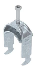
Staffa reggicavo con base a testa di martello, coppa in metallo con bordi arrotondati per la protezione del cavo. Per il montaggio verticale e orizzontale di 1 cavo singolo su profilato a C. Per dimensioni scanalatura di 16-17 mm. Con coppa di pressione, testa a vite esagonale universale SW10, intaglio a croce e a taglio. Per il montaggio in ambiente interno ed esterno. La controcoppa deve essere ordinata separatamente.
