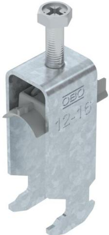
Staffa reggicavo con ancoraggio tipo H, coppa plastica in polipropilene. Per il montaggio verticale e orizzontale di 2 cavi singoli su profilato a C con scanalatura di larghezza 16 - 17 mm. Dotata di vite SW10 per il serraggio della coppa tramite testa esagonale o intaglio a croce. Per il montaggio in ambiente interno ed esterno. Separazione tra due cavi garantita dalla coppa doppia. Si raccomanda l'uso della controcoppa, da ordinare separatamente.
