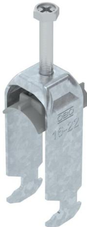
Staffa reggicavo con ancoraggio tipo H, coppa plastica in polipropilene. Per il montaggio verticale e orizzontale di 2 cavi singoli su profilato a C con scanalatura di larghezza 16 - 17 mm. Dotata di vite SW10 per il serraggio della coppa tramite testa esagonale o intaglio a croce. Per il montaggio in ambiente interno ed esterno. Separazione tra due cavi garantita dalla coppa doppia. Si raccomanda l'uso della controcoppa, da ordinare separatamente.
