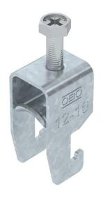
Staffa reggicavo con ancoraggio tipo U, coppa in metallo con bordi arrotondati a protezione del cavo. Per il montaggio verticale e orizzontale di 1 cavo singolo su profilato a C con scanalatura di larghezza 18 - 22 mm. Dotata di vite SW10 per il serraggio della coppa tramite testa esagonale o intaglio a croce. Per il montaggio in ambiente interno ed esterno. Si raccomanda l'uso della controcoppa, da ordinare separatamente.
