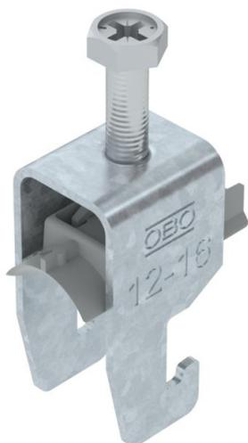
Staffa reggicavo con ancoraggio tipo U, coppa plastica in polipropilene. Per il montaggio verticale e orizzontale di 1 cavo singolo su profilato a C con scanalatura di larghezza 18 - 22 mm. Dotata di vite SW10 per il serraggio della coppa tramite testa esagonale o intaglio a croce. Per il montaggio in ambiente interno ed esterno. Separazione dei due cavi garantiti dalla coppa doppia. Si raccomanda l'uso della controcoppa, da ordinare separatamente.
