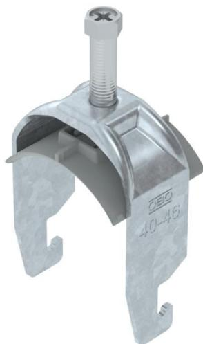
Staffa reggicavo con ancoraggio tipo U, coppa plastica in polipropilene. Per il montaggio verticale e orizzontale di 1 cavo singolo su profilato a C con scanalatura di larghezza 18 - 22 mm. Dotata di vite SW10 per il serraggio della coppa tramite testa esagonale o intaglio a croce. Per il montaggio in ambiente interno ed esterno. Separazione dei due cavi garantiti dalla coppa doppia. Si raccomanda l'uso della controcoppa, da ordinare separatamente.
