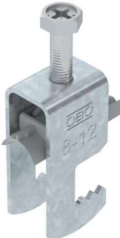
Staffa reggicavo con ancoraggio tipo F, coppa plastica in polipropilene. Per il montaggio verticale e orizzontale di 1 cavo singolo su profilato piatto. Dotata di vite SW10 per il serraggio della coppa tramite testa esagonale o intaglio a croce. Per il montaggio in ambiente interno ed esterno. Si raccomanda l'uso della controcoppa, da ordinare separatamente.
