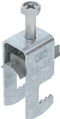
Staffa reggicavo con ancoraggio tipo F, coppa plastica in polipropilene. Per il montaggio verticale e orizzontale di 1 cavo singolo su profilato piatto. Dotata di vite SW10 per il serraggio della coppa tramite testa esagonale o intaglio a croce. Per il montaggio in ambiente interno ed esterno. Si raccomanda l'uso della controcpoppa, da ordinare separatamente.
