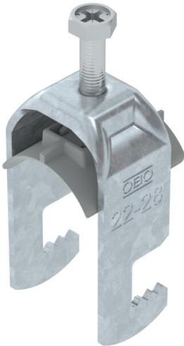
Staffa reggicavo con ancoraggio tipo F, coppa plastica in polipropilene. Per il montaggio verticale e orizzontale di 1 cavo singolo su profilato piatto. Dotata di vite SW10 per il serraggio della coppa tramite testa esagonale o intaglio a croce. Per il montaggio in ambiente interno ed esterno. Si raccomanda l'uso della controcpoppa, da ordinare separatamente.
