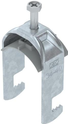
Staffa reggicavo con ancoraggio tipo F, coppa plastica in polipropilene. Per il montaggio verticale e orizzontale di 1 cavo singolo su profilato piatto. Dotata di vite SW10 per il serraggio della coppa tramite testa esagonale o intaglio a croce. Per il montaggio in ambiente interno ed esterno. Si raccomanda l'uso della controcoppa, da ordinare separatamente.
