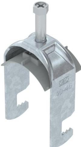
Staffa reggicavo con ancoraggio tipo F, coppa plastica in polipropilene. Per il montaggio verticale e orizzontale di 1 cavo singolo su profilato piatto. Dotata di vite SW10 per il serraggio della coppa tramite testa esagonale o intaglio a croce. Per il montaggio in ambiente interno ed esterno. Si raccomanda l'uso della controcpoppa, da ordinare separatamente.
