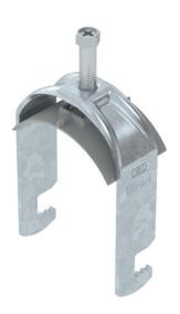
Staffa reggicavo con ancoraggio tipo F, coppa plastica in polipropilene. Per il montaggio verticale e orizzontale di 1 cavo singolo su profilato piatto. Dotata di vite SW10 per il serraggio della coppa tramite testa esagonale o intaglio a croce. Per il montaggio in ambiente interno ed esterno. Si raccomanda l'uso della controcoppa, da ordinare separatamente.
