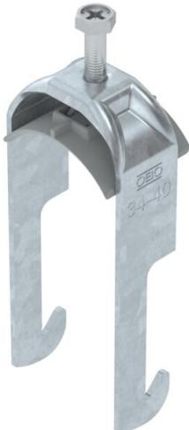
Staffa reggicavo con ancoraggio tipo W, coppa plastica in polipropilene. Per il montaggio verticale e orizzontale di 1 cavo singolo su profilato angolare fino a <40 mm. Dotata di vite SW10 per il serraggio della coppa tramite testa esagonale o intaglio a croce. Per il montaggio in ambiente interno ed esterno. Si raccomanda l'uso della controcoppa, da ordinare separatamente.
