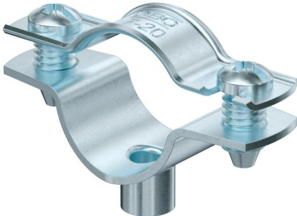
Collare di fissaggio per il montaggio di tubi e cavi a parete, soffitto e pavimento. Con elemento superiore autobloccante. Fissaggio sopra supporto con filettatura interna.
