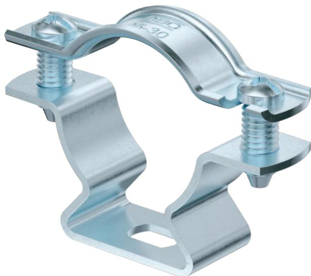
Supporto distanziatore per il montaggio di tubi e cavi a parete, soffitto e pavimento. Con parte superiore autobloccante. Fissaggio tramite foro ovale. A partire dalla dimensione 20 delle fascette idoneità per il montaggio con sparabulloni o sparachiodi.
