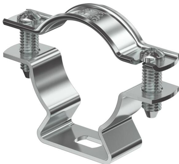
Collare di fissaggio per il montaggio di tubi e cavi a parete, soffitto e pavimento. Con elemento superiore autobloccante. Fissaggio tramite foro ovale. A partire dalla dimensione 20 dei collari idoneità per il montaggio con sparabulloni o sparachiodi.
