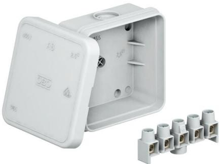
Grado di protezione IP55, tensione nominale 690 V, sezione nominale 2,5 mm<sup>2</sup>, 7 ingressi per diametro cavo 5-14 mm.
