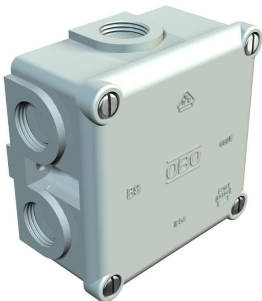
Grado di protezione IP54, tensione nominale 660 V, sezione nominale 2,5 - mm<sup>2</sup>, 2 fori di fissaggio per viti di Ø fino a 5 mm nella parte esterna della scatola, 4 viti di copertura, 7 fori entrate cavi apribili con filettatura M20 x 1,5, preferibilmente per pressacavi aventi attacco filettato corto.
