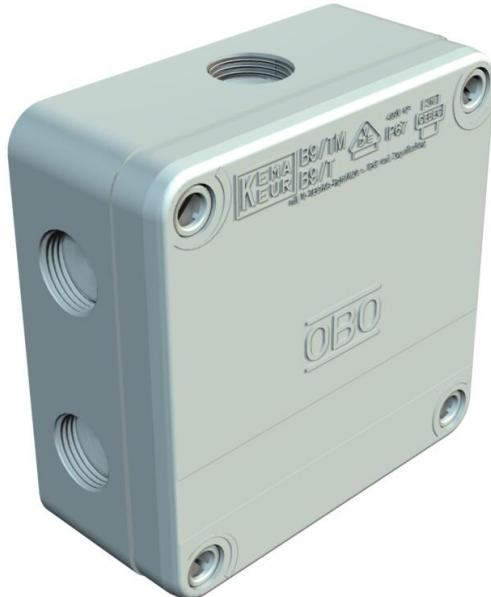
Scatola di derivazione B9/T... composta da due diversi componenti in plastica privi di alogenri. Presenta 8 ingressi filettati con membrane di perforazione (7 x M20 di lato e 1 x PG16 nel fondo), nonché un ingresso con membrana nel fondo per diametro massimo del cavi di 15 mm.
