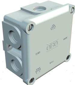
Grado di protezione IP54, tensione nominale 660 V, sezione nominale 2,5 - 4 mm<sup>2</sup>, in combinazione con la morsettiera 700/6 M la scatola ha la sezione nominale pari a 4 mm<sup>2</sup>, 2 fori di fissaggio per viti fino a 5 mm di Ø sulla parte esterna della scatola. 4 viti di copertura, 7 fori entrate cavi apribili con filettatura M20 x 1,5, preferibilmente per pressacavi aventi attacco filettato corto.
