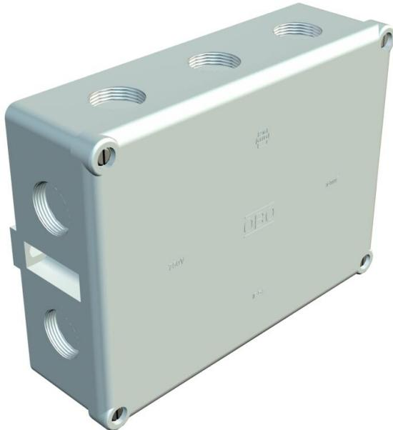
Grado di protezione IP54, tensione nominale 660 V, sezione nominale 16 - mm<sup>2</sup>, 2 fori di fissaggio per viti di Ø fino a 6 mm sulla parte esterna della scatola. 4 viti di copertura, 10 fori passanti sfondabili con filettatura M25 x 1,5.
