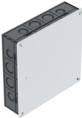
Scatola di derivazione da incasso per il bloccaggio di morsetti, impiego in muratura con profondità di installazione di almeno 65 mm. Con coperchio e viti del coperchio (15 mm). Bordo piano del coperchio, superficie del coperchio ruvida.
