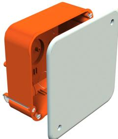
Scatola di derivazione per intercapedini per l'impiego in intercapedini con una profondità di installazione di almeno 50 mm e uno spessore pannelli di 7 - 35 mm. Con coperchio bianco e viti del coperchio Adatta per il montaggio di profilati a norma (profilati di sospensione e di supporto) per morsetti in linea.
