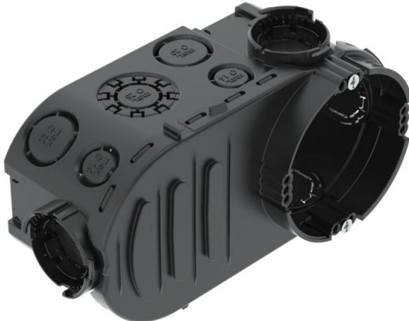
Scatola elettronica da incasso con vano morsetti supplementare, per impiego in muratura con profondità di installazione di almeno 66 mm.
