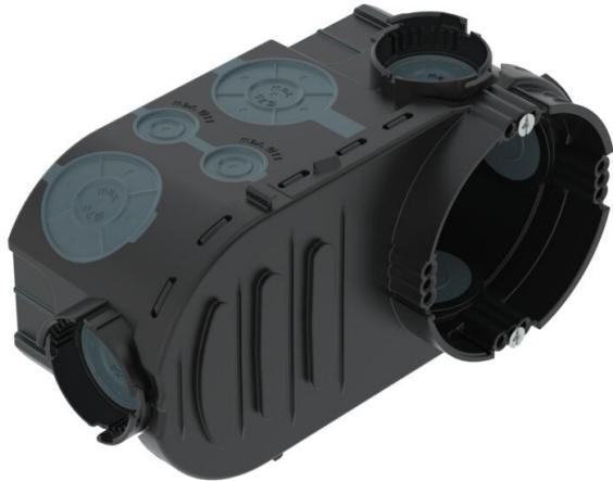
Scatola elettronica da incasso con vano morsetti supplementare e ingressi a membrana ermetici, per impiego in muratura con profondità di installazione di almeno 67 mm.
