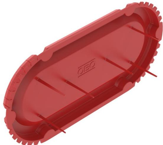
Coperchio di protezione per scatole da incasso doppie, da utilizzare durante l'intonacatura. Di colorazione rossa, con setole di segnalazione per la determinazione della posizione e lingue per la rimozione.
