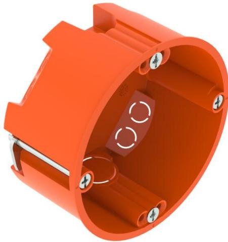
Scatola apparecchi per intercapedini per l'impiego in intercapedini con una profondità di installazione di almeno 35 mm e uno spessore pannelli di 5 - 28 mm.
