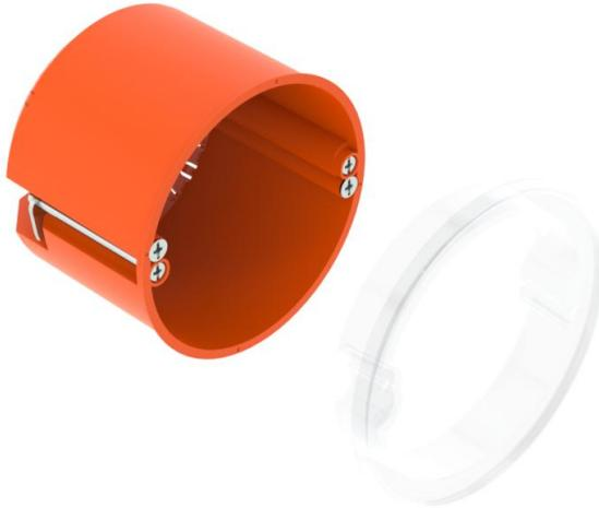
Scatola apparecchi per intercapedini CEE/PERILEX con anello di tenuta per l'impiego in intercapedini con una profondità di installazione di almeno 61 mm e uno spessore pannelli di 5 - 40 mm.
