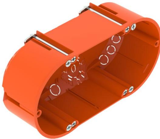
Scatola apparecchi per intercapedini doppia CEE/PERILEX per l'impiego in intercapedini con una profondità di installazione di almeno 61 mm e uno spessore pannelli di 5 - 40 mm.
