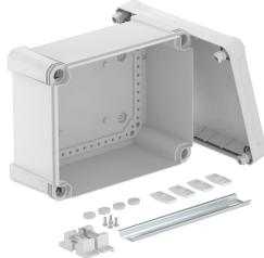
Scatola di derivazione con profilato per il collegamento di cavi e linee in ambienti interni e ambienti esterni. Forma rettangolare senza ingressi. Adatta per il montaggio su pareti e soffitti con la possibilità di fissaggio esterno e interno o il montaggio su sezioni angolari. Resistente agli urti IK09. Coperchio con chiusura rapida, piombabile. Costruito con materiali privi di alogenici e resistenti ai raggi UV. Include profilato tipo 2069 e set di fissaggio.
