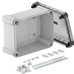
Scatola di derivazione con profilato per il collegamento di cavi e linee in ambienti interni e ambienti esterni. Forma rettangolare senza ingressi. Adatta per il montaggio su pareti e soffitti con la possibilità di fissaggio esterno e interno o il montaggio su sezioni angolari. Resistente agli urti IK09. Coperchio trasparente con chiusura rapida, piombabile. Costruito con materiali privi di alogenzi e resistenti ai raggi UV. Include profilato tipo 2069 e set di fissaggio.
