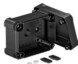
Scatola di derivazione per il collegamento di cavi e linee in ambienti interni e ambienti esterni. Forma rettangolare senza ingressi. Adatta per il montaggio su pareti e soffitti con la possibilità di fissaggio esterno e interno o il montaggio su sezioni angolari. Resistente agli urti IK09. Coperchio con chiusura rapida, piombabile. Costruito con materiali privi di alogeni e resistenti ai raggi UV.
