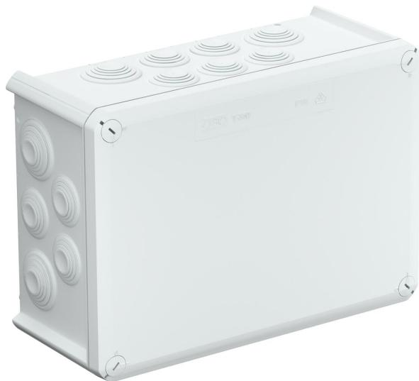
Scatola di derivazione per il collegamento di cavi e linee in ambienti interni e ambienti esterni protetti. Forma rettangolare con passacavi sui lati e inserti nel fondo. Adatta per il montaggio su pareti e soffitti e il montaggio su piastre di montaggio. Con la possibilità di fissaggio interno e montaggio tramite cupole angolari. Coperchio con chiusura rapida, piombabile. Costruito con materiali privi di alogenini e resistenti ai raggi UV.
