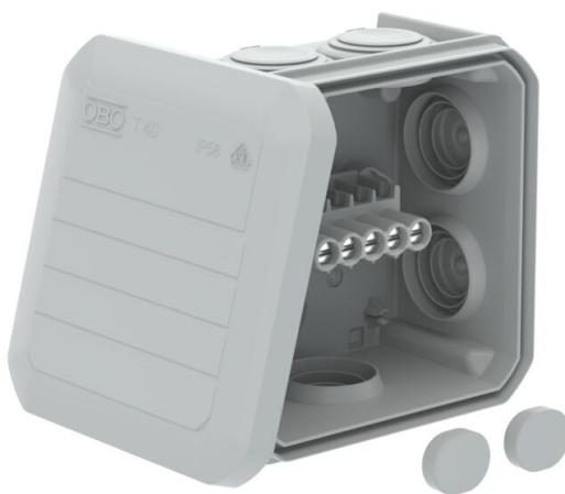
Scatola di derivazione con morsettiera per il collegamento di cavi e linee in ambienti interni ed ambienti esterni protetti. Forma quadrata con tenute ad innesto sui lati e inserti di deviazione nel pavimento. Adatta per il montaggio su pareti e soffitti e il montaggio su piastre di montaggio. Con la possibilità di fissaggio interno. Con coperchio morsetto fisso. Costruito con materiali privi di alogenzi e resistenti ai raggi UV.
