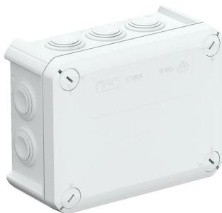
Scatola di derivazione per il collegamento di cavi e linee in ambienti interni e ambienti esterni protetti. Forma rettangolare con passacavi sui lati e inserti nel fondo. Adatta per il montaggio su pareti e soffitti e il montaggio su piastre di montaggio. Con la possibilità di fissaggio interno e montaggio tramite cupole angolari. Coperchio con chiusura rapida, piombabile. Costruito con materiali privi di alogenini e resistenti ai raggi UV.
