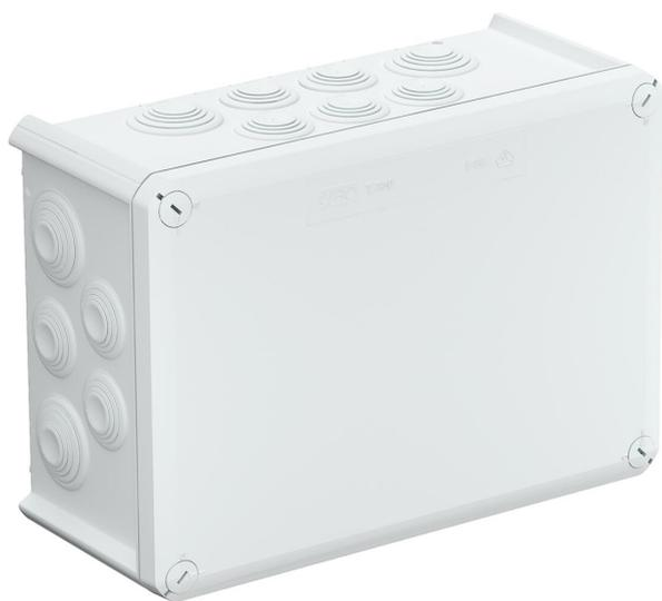
Scatola di derivazione per il collegamento di cavi e linee in ambienti interni e ambienti esterni protetti. Forma rettangolare con passacavi sui lati e inserti nel fondo. Adatta per il montaggio su pareti e soffitti e il montaggio su piastre di montaggio. Con la possibilità di fissaggio interno e montaggio tramite cupole angolari. Coperchio con chiusura rapida, piombabile. Costruito con materiali privi di alogeni e resistenti ai raggi UV.
