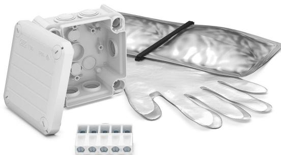
Kit composto da scatola di derivazione T 60 con morsettiera, resina colata e un paio di guanti monouso. Resina colata bicomponente in sacchetto di miscelazione per la protezione delle installazioni elettriche contro l'umidità secondo la classe di protezione IP 68 e contro le sollecitazioni meccaniche. La resina colata ha una temperatura di indurimento bassa e una temperatura di lavorazione di 0-35 °C. La quantità di resina colata contenuta corrisponde al volume della cassetta.
