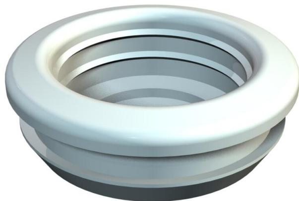
Niplo di montaggio chiuso con membrana perforabile per cavi di diametro 12-16 mm. Ideale per un semplice inserimento di cavi e linee in alloggiamenti o attraverso lamiere sottili.
