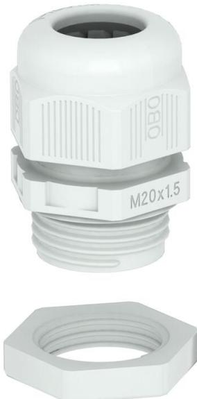
Pressacavo con filettatura metrica, adatto per scatole di derivazione, per applicazioni residenziali ed industriali. Con scarico della trazione e guarnizione di tenuta integrata, testato secondo norma CEI EN 62444. Grado di protezione IP68. Range temperatura -20°C a +65°C. Controdado incluso.
