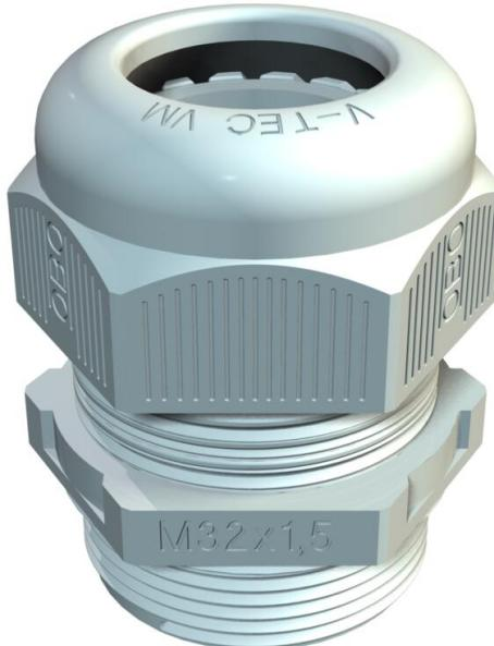
Pressacavo con filettatura metrica, adatto per scatole di derivazione, per applicazioni residenziali ed industriali. Con scarico della trazione e guarnizione di tenuta integrata, testato secondo norma CEI EN 62444. Grado di protezione IP68. Range temperatura -20°C a +65°C.
