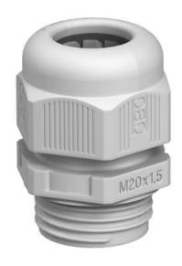
Pressacavo con filettatura metrica, adatto per scatole di derivazione, per applicazioni residenziali ed industriali. Con scarico della trazione e guarnizione di tenuta integrata, testato secondo norma CEI EN 62444. Grado di protezione IP68. Range temperatura -20°C a +65°C.
