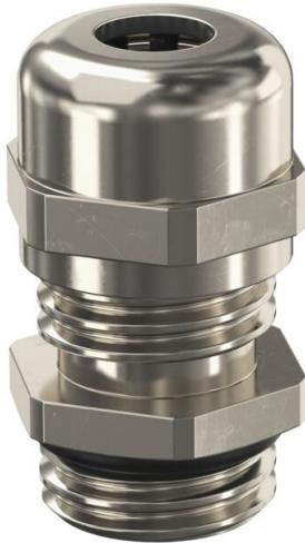
Pressacavo con filettatura di raccordo metrica, dotato di dado cieco, secondo IEC 423. Scarico di trazione, protezione antitorsione e tenuta sull'intero campo di serraggio. Guarnizione in neoprene. Inserto di fissaggio in poliammide.
