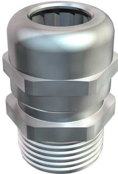
Pressacavo EMV con filettatura di raccordo metrica, dotato di dado cieco, secondo IEC 423. Scarico di trazione, protezione antitorsione e tenuta sull'intero campo di serraggio. Se utilizzato con scatole di derivazione con pareti spesse, aggiungere il controdado. Guarnizione in neoprene. Inserto di fissaggio in poliammide.
