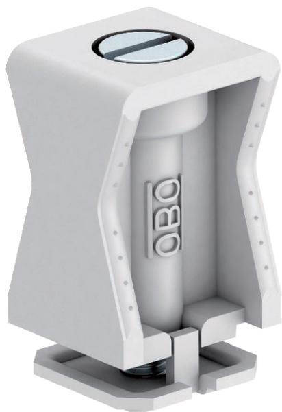
Anche adatto a profilati con dimensioni della scanalatura 11 - 12 mm; corpo morsetto in polistirolo privo di alogeni, grigio chiaro RAL 7035; Parte metallica in acciaio zincato galvanicamente.
