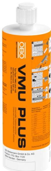
Malta chimica in vinilestere senza stirene per l'ancoraggio senza espansione per carichi elevati con barre di ancoraggio filettate. Cartuccia coassiale compreso 1 tubo di miscelazione per la lavorazione con pistola a pressione del tipo VM-P 380 professionale.
