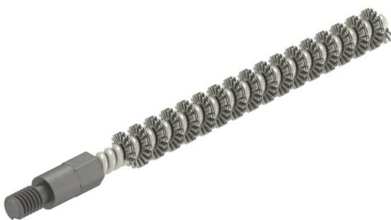
Spazzola in acciaio, secondo omologazione tecnica, utilizzata per la pulizia dei fori dei tasselli, per ottenere una superficie pulita prima dell'iniezione della malta.
