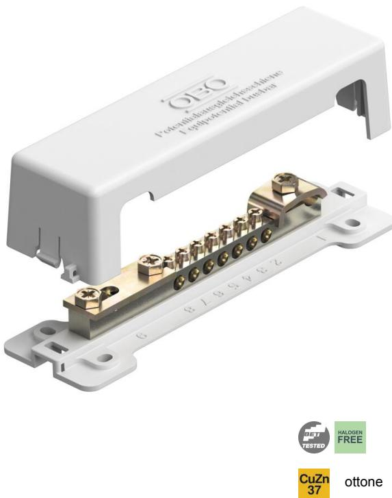
La Barra equipotenziale OBO Green è una soluzione realizzata in acetato di cellulosa CA per l'installazione del sistema di equipotenzializzazione secondo DIN VDE 0100-410/-540 e dell'equipotenzializzazione con parafulmine secondo DIN VDE 0185-305. Il prodotto di base del materiale è un materiale collaudato dell'industria cartacea.
