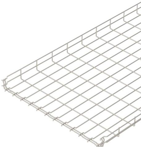
Passerella grigliata ad innesto rapido, con bordo di altezza pari a 55 mm. Per la passerella grigliata non sono necessari ulteriori componenti di collegamento in quanto vengono semplicemente inserite l'una nell'altra. La larghezza della maglia è di 50 x 100 mm (eccezione GRM 55/50 = 20 x 100 mm). Schermatura magnetica senza coperchio 15 dB, con coperchio 25 dB.
